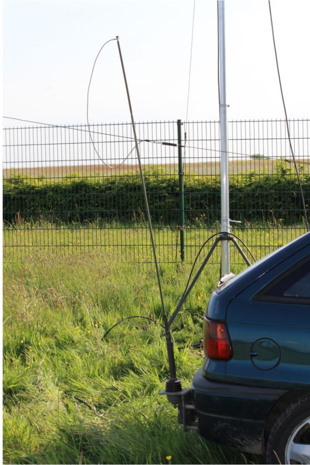
**PHOTO 3 : autre vue de la base du fil, remarquer l'isolateur et le hauban de tension.**
