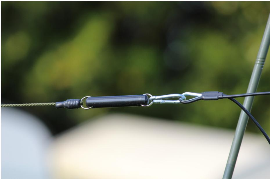
***PHOTO 6 : gros plan sur l'isolateur et le système du Raccordement de l'antenne sur la drisse.***
