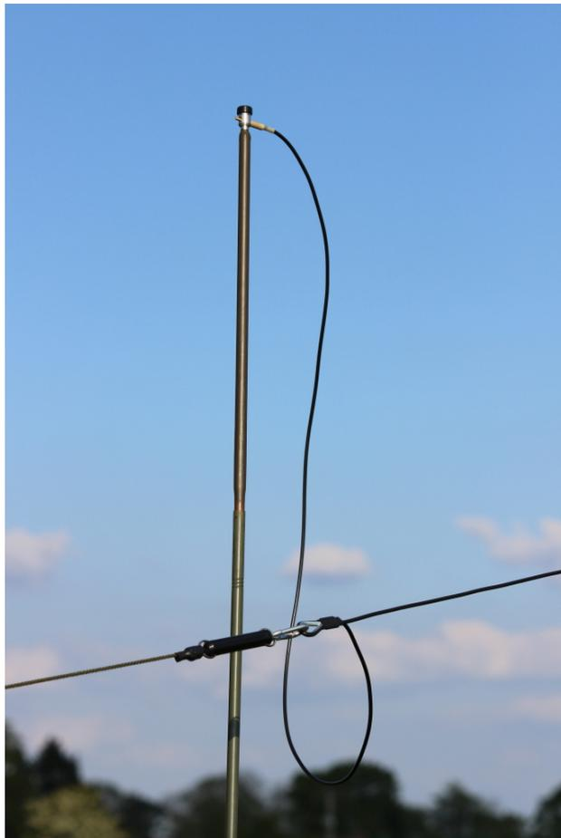
**PHOTO 4 : vue rapprochée du raccordement sur l'antenne du véhicule montrant le brin coupé à 30 cm.**
