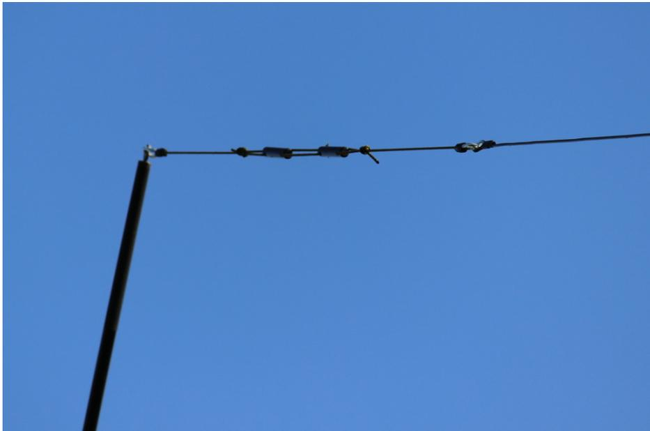
**PHOTO 8 : extrémité supérieure de l'antenne avec les isolateurs.**
