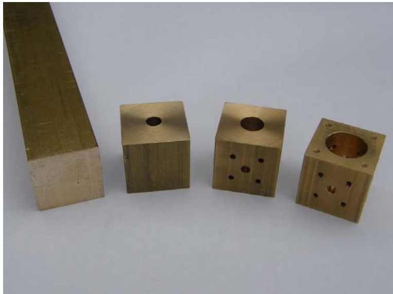
PHOTO 2 : Différents stades d'usinage de la tête en laiton
