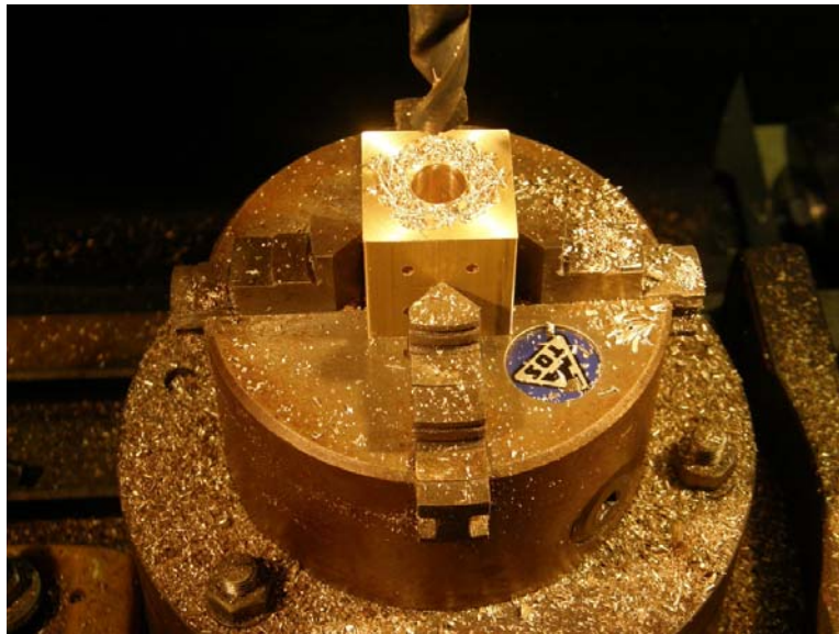
PHOTO 1 : La tête en laiton en cours d'usinage sur ma fraiseuse
