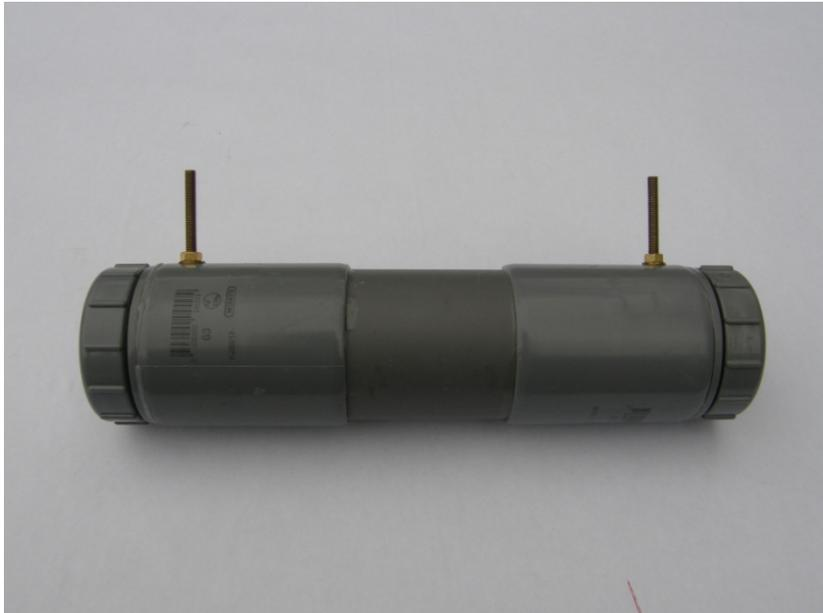
**PHOTO 6 : la trappe assemblée et fermée, les tiges filetées servent à fixer l'isolateur et à raccorder les brins de l'antenne.**
