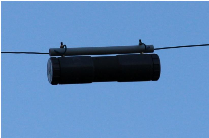
**PHOTO 7 : Une des deux trappes montées sur ma W3DZZ.**
