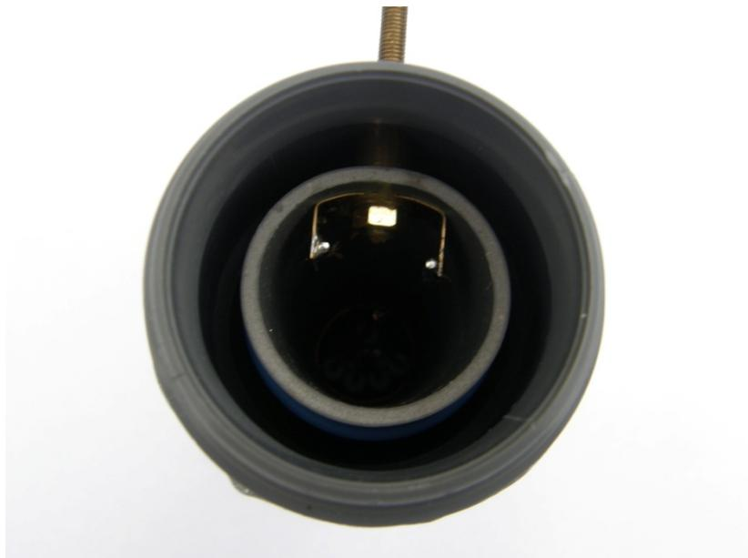
**PHOTO 5 : vue d'extrémité après assemblage, remarquer la languette Repliée sur laquelle sont soudés la bobine et le condensateur.**
